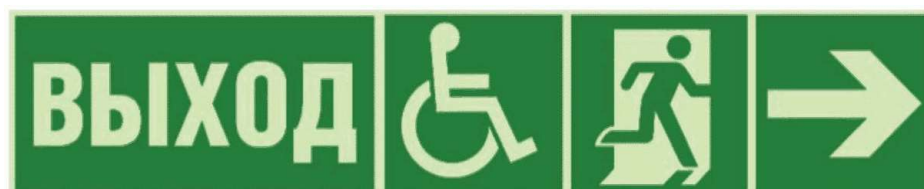
Рисунок 5 - Пример комбинации эвакуационных знаков
